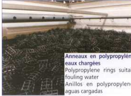
Corps d'échange type film matière plastique eaux claires et chargées Plastic film type for fouling and nonfouling water Cuerpo de intercambio tipo cinta material plastica para aguas claras y cargadas
