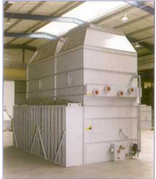
Tour mixte avec traitement acoustique et hotte au refoulement
